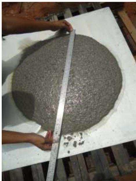
**Figura 2:** *Slump Flow*
