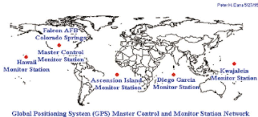
Figura 2: Segmento de controle - Estações de controle do GPS
