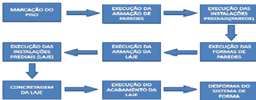
Figura 2 - Ciclo de concretagem
