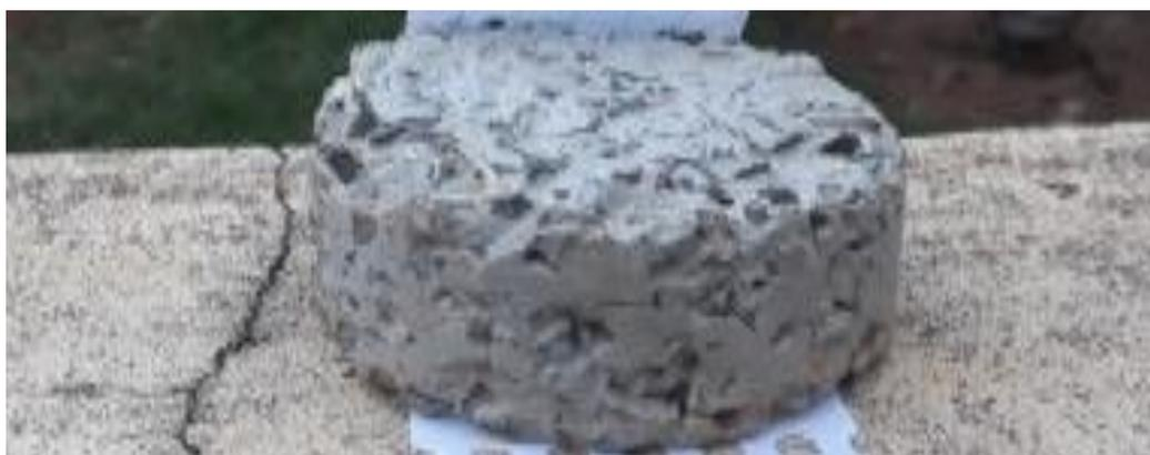
**Figura 15** - Resultado Amostra 2. A amostra apresentou boa resistência à compressão, pouca resistência à tração conforme se observa em todos os tipos de concreto e apresentou boa permeabilidade, porém as bordas se desagregaram com muita facilidade.
