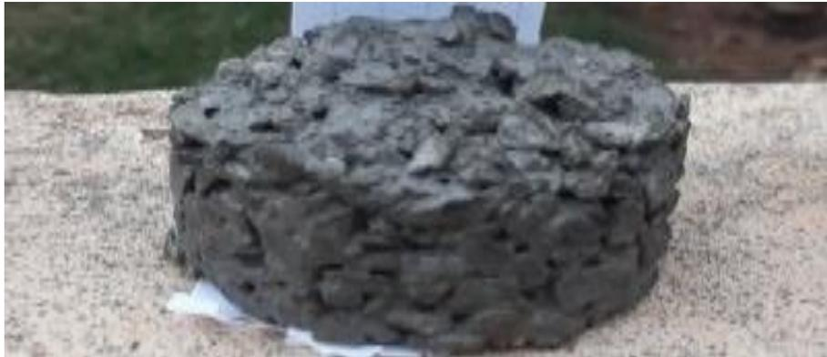
**Figura 16** - Amostra 3. Amostra não apresentou resistência à compressão, também não apresentou resistência à tração e não apresentou permeabilidade, porém toda a amostra se desagrega com muita facilidade, constatou-se imprópria para uso.
