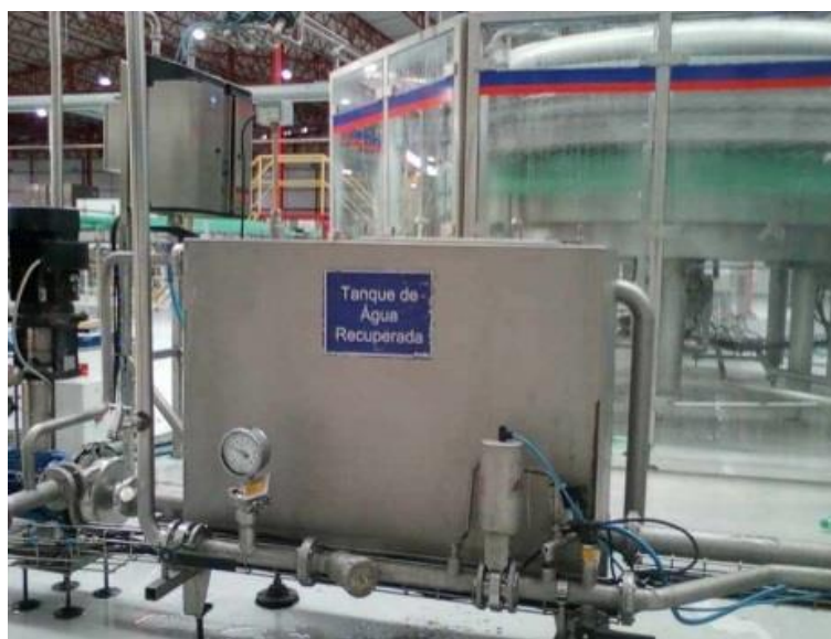
Figura 12- Sistema de reaproveitamento de água do rinser de latas.
