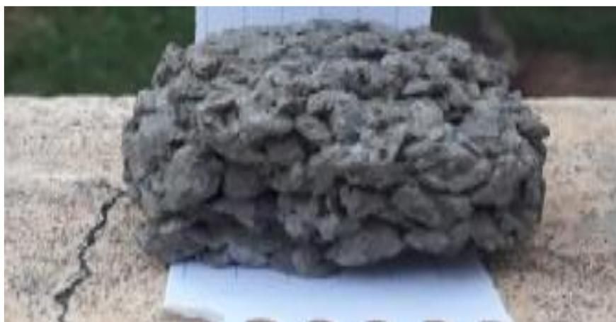
**Figura 18** - Amostra 5. Amostra apresentou boa resistência à compressão, pouca resistência à tração conforme se observa em todos os tipos de concreto e apresentou ótima permeabilidade, se mostrando ideal para utilização de piso permeável.
