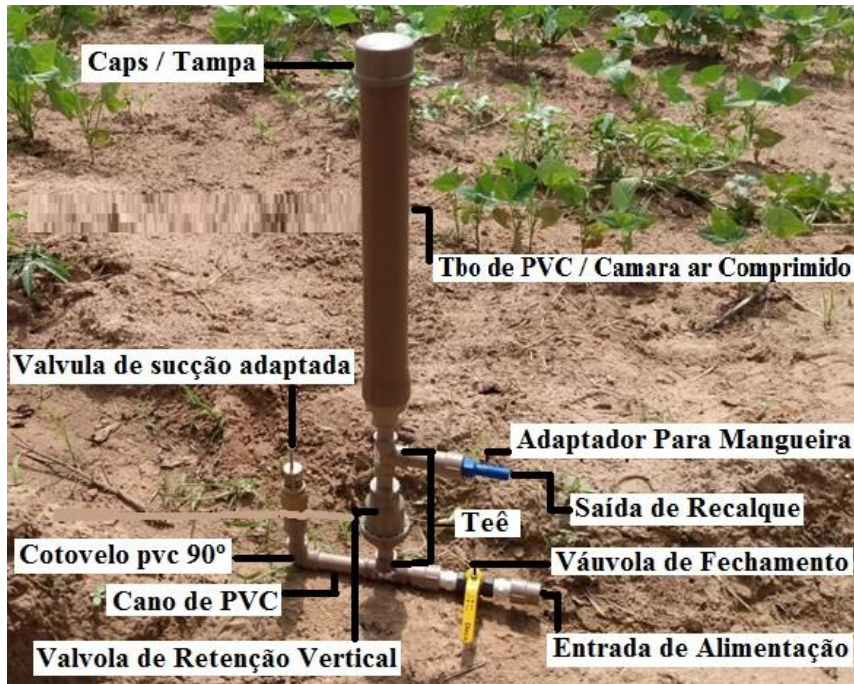
Figura 6 – Carneiro hidráulico em campo.
