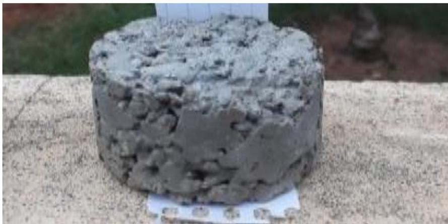
**Figura 17** - Amostra 4. Amostra apresentou boa resistência à compressão, pouca resistência à tração conforme se observa em todos os tipos de concreto e apresentou baixa permeabilidade.
