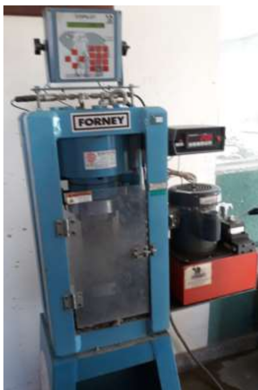
Figura 5 – Prensa hidráulica onde foram realizados os ensaios de compressão
